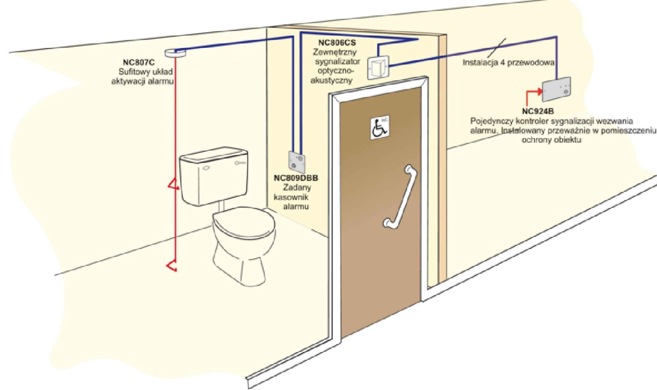
Przykładowy schemat oprzewodowania toalety dla jednego zestawu NC951
